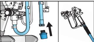
**5** Revissez la crépine sur le tuyau d'aspiration. Assurez-vous que le pistolet et le flexible restent bien attachés au pulvérisateur.
