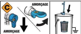
**2** Mettez la vanne d'amorçage/pulvérisation en position d'AMORÇAGE. Mettez le tuyau de vidange dans le seau à déchets. Tournez le bouton de réglage de pression en position START (DÉMARRAGE).
