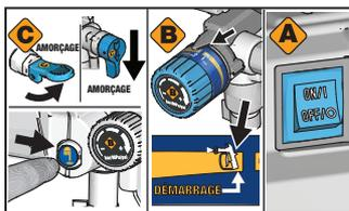
**3** Mettez la vanne d'amorçage/de pulvérisation en position AMORÇAGE. Appuyez sur le bouton PushPrime\* deux fois pour desserrer la bille de la vanne d'entrée. Mettez le bouton de réglage de pression en position START (DÉMARRAGE). Mettez l'interrupteur principal sur ON (MARCHÉ).
