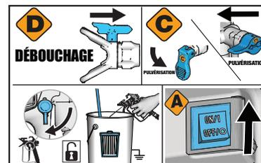
**6** Tournez la buse de pulvérisation en position DÉBOUCHAGE. Déverrouillez la gâchette. Orientez le pistolet dans le seau à déchets, tirez la gâchette et maintenez-la dans cette position. Abaissez la vanne d'amorçage/de pulvérisation en position PULVÉRISATION et mettez l'interrupteur principal sur ON (MARCHÉ).
