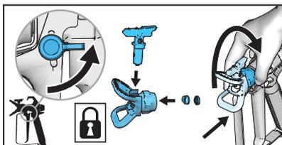
**2** Verrouillez la gâchette. Veillez à ce que la buse de pulvérisation soit correctement insérée dans le garde-buse et que ce dernier soit correctement serré sur le pistolet.
