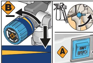
**6** Tournez le bouton de réglage de pression sur le réglage le plus bas et relâchez la gâchette. Verrouillez la gâchette. Mettez la vanne d'amorçage/de pulvérisation sur PRIME (AMORÇAGE) et mettez l'interrupteur principal sur OFF (ARRÊT).
