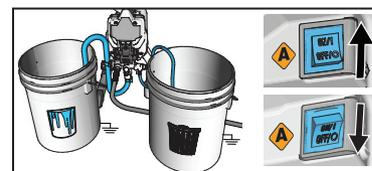
**5** Plongez le tuyau d'aspiration dans la peinture. Mettez l'interrupteur principal en position ON (MARCHÉ) et attendez que la peinture sorte du tuyau de vidange. Mettez l'interrupteur principal en position OFF (ARRÊT).
