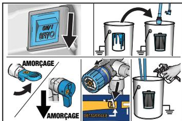
**1** Mettez l'interrupteur principal sur OFF (ARRÊT). Plongez le tuyau d'aspiration et le tuyau de vidange dans le seau à déchets. Mettez la vanne d'amorçage/pulvérisation en position d'AMORÇAGE. Tournez le bouton de réglage de pression en position START (DÉMARRAGE). Actionnez le pistolet dans le seau à déchets.
