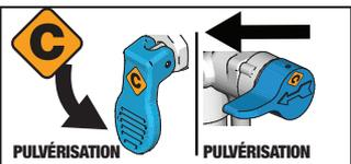
**6** Abaissez la vanne de pulvérisation/d'amorçage en position PULVÉRISATION pour le stockage. Mettez l'interrupteur principal en position OFF (ARRÊT) et débranchez le pulvérisateur de la prise.
