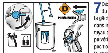
**7** Dès que la peinture commence à s'écouler du pistolet, relâchez la gâchette. Verrouillez la gâchette. Transférez le tuyau de vidange dans le seau de peinture et fixez-le au tuyau d'aspiration. Faites tourner la buse de pulvérisation vers l'arrière pour la mettre en position PULVÉRISATION et assurez-vous que le garde-buse est bien serré.
