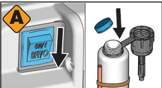
**4** Lorsque le Pump Armor qui se trouve dans le pulvérisateur est rincé, mettez l'interrupteur principal en position OFF (ARRÊT). Remplacez et serrez le capuchon de sécurité pour le stockage.
