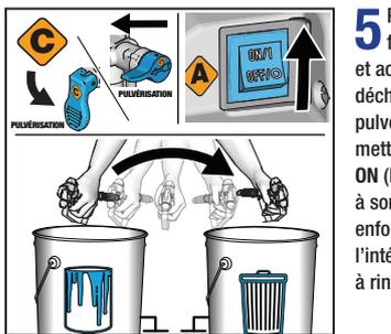
**5** Pour garder de la peinture dans le flexible, déverrouillez la gâchette et actionnez le pistolet dans un seau à déchets, abaissez la vanne d'amorçage/pulvérisation en position PULVÉRISATION et mettez l'interrupteur principal en position ON (MARCHÉ). Lorsque l'eau commence à sortir du pistolet, maintenez la gâchette enfoncée et dirigez le pistolet vers l'intérieur du seau à déchets. Continuez à rincer jusqu'à ce que l'eau soit claire.
