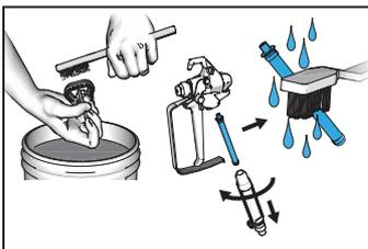
**7** Nettoyez la buse de pulvérisation, le garde-buse et la crépine avec une brosse. Retirez le filtre de pistolet et nettoyez-le. Remontez le filtre de pistolet, la buse et le garde-buse.
