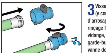
**3** Vissez la vanne de rinçage forcé (y compris le pulvérisateur) sur un tuyau d'arrosage. Ouvrez l'eau. Ouvrez la vanne de rinçage forcé. Rincez les tuyaux d'aspiration et de vidange, la crépine, la buse de pulvérisation et le garde-buse pour éliminer la peinture. Fermez la vanne de rinçage forcé.
