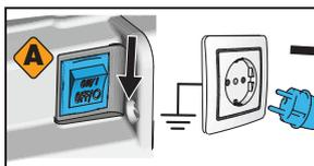
**1** Mettez l'interrupteur principal en position OFF et branchez la prise électrique.
