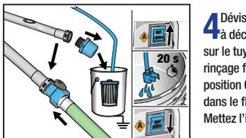
**4** Dévissez la crépine et mettez-la dans le seau à déchets. Vissez la vanne de rinçage forcé sur le tuyau d'aspiration. Ouvrez la vanne de rinçage forcé. Mettez l'interrupteur principal en position ON (MARCHÉ) et laissez l'eau s'écouler dans le flexible de vidange pendant 20 secondes. Mettez l'interrupteur principal sur OFF (ARRÊT).
