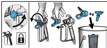
**2** Verrouillez la gâchette. Retirez le garde-buse du pistolet et déposez-le dans le seau à déchets.
