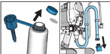
**1** Retirez le capuchon de bouteille de Pump Armor et le joint de feuille. Si nécessaire, dévissez le tamis d'entrée du tuyau d'aspiration.
